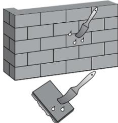
Поверхность, на которую будет укладываться камень, должна быть твердой, ровной и чистой. Перед началом укладки рекомендуется увлажнить, обработать поверхность грунтом глубокого проникновения и рабочую сторону камня с помощью малярной кисти. Прикрепить оцинкованную сетку с диаметром прутка от 1 до 3 мм при весе камня от 25 кг на кв.м.
