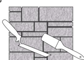
После того, как расшивочный состав слегка схватится, шпателем для расшивки выдавливающими движениями разгладьте швы и удалите излишки раствора. Затем жесткой щеткой (не металлической!) или кистью окончательно зачистите поверхность.
