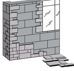
В первую очередь укладываются декоративные элементы (обрамления окон и дверей, русты, карнизы и пр.). Угловые элементы следует укладывать, чередуя длинные и короткие стороны. Затем камень укладывается по направлению от внешних углов и проемов (окна и двери) в сторону ровных стен.
