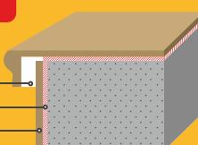
Основание для облицовки должно быть предварительно подготовленным: ровным, иметь достаточную несущую способность, очищенным от пыли. Перед укладкой следует сделать предварительный расчет материала, ознакомиться с инструкцией к сухим строительным смесям и убедиться, что область применения плиточного клея пригодна для укладки клинкерной плитки.
