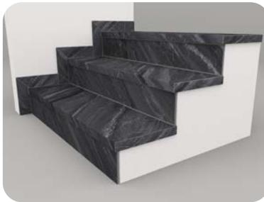
Para una correcta colocación del material y garantizar la durabilidad es recomendable utilizar ahesive tipo C2 TE S1 y material para juntas tipo CG2.
