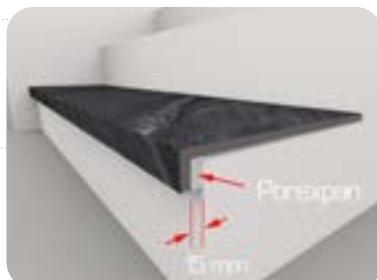
Deberemos dejar 15 mm de vuelo entre la pared frontal y la parte interior del perfil delantero del peldaño. Esta separación la deberemos llenar con algún elemento flexible como, porexpan, espuma o masilla elástica.
