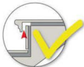
Рекомендуем производить укладку с учетом воздушного зазора 3–4 мм.
